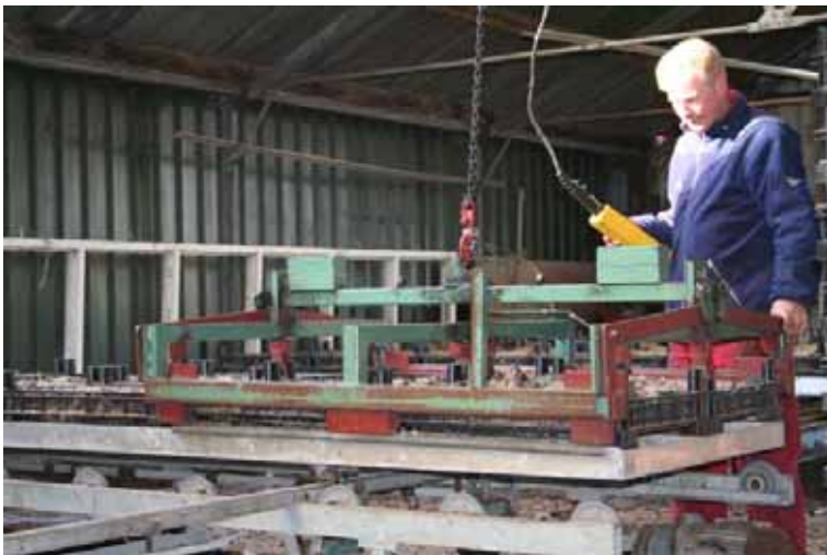
Stationaire bakkenklem voor het plaatsen van broeifust op en van transporttafels
