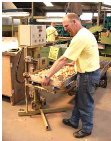
Fustheffer in opstelling achter telmachine
