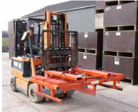
Bakkenklem aan elektro stapelaar tijdens inhalen in de kas (foto links) en aan heftruck tijdens ledigen van de bakken (foto rechts)
