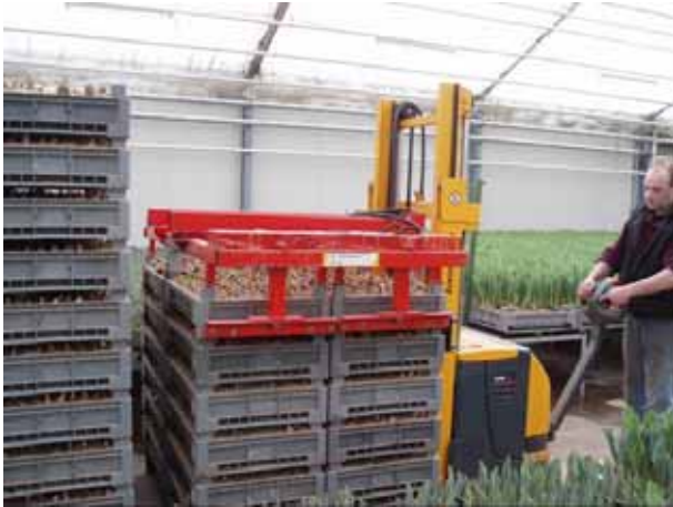
Bakkenklem aan elektro stapelaar tijdens inhalen in de kas (foto links) en aan heftruck tijdens ledigen van de bakken (foto rechts)
