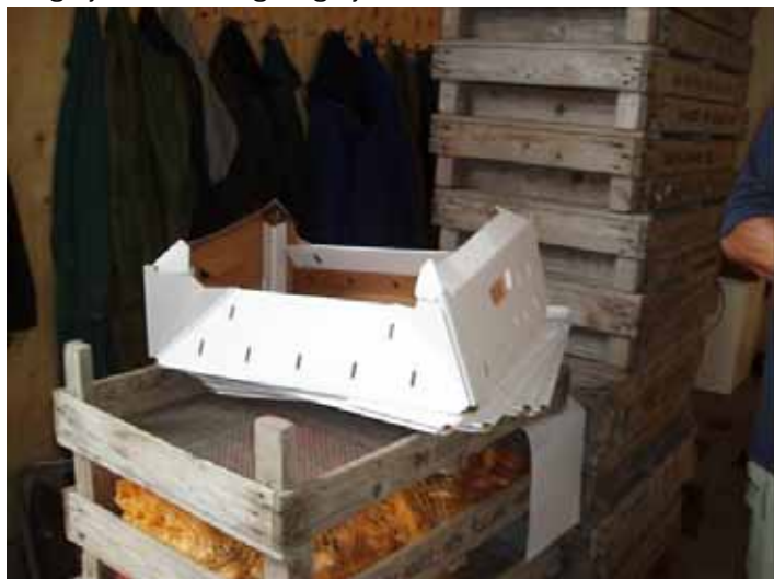
Kartonnen fust is niet stevig genoeg om met klemmen op te pakken.
