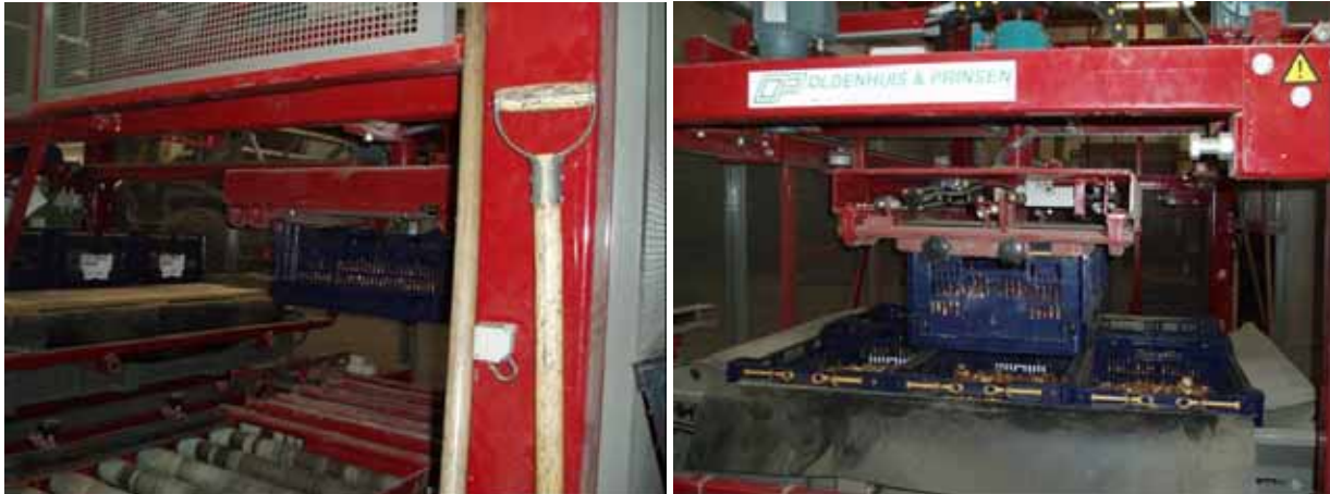
De universele pallettiseermachine van Oldenhuis & Prinsen pakt fust op vanaf de rollenband die de machine in loopt (foto links) en stapelt die op een pallet of onderzetter (foto rechts).
