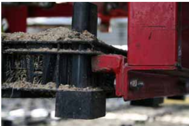
De stapelaar van de zelfrijdende bakkenklem in portaalwagen tilt het fust aan de bovenrand op
