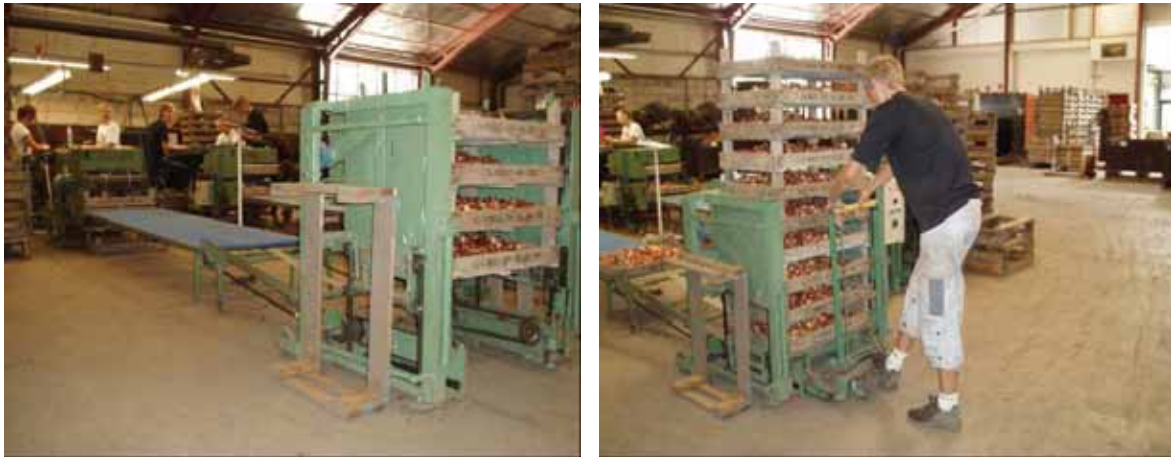
Stapelaar achter de telband (foto links). Als de stapel de gewenste hoogte heeft wordt deze met een steekkarretje weggereden (foto rechts en paragraaf 3.1.9)
