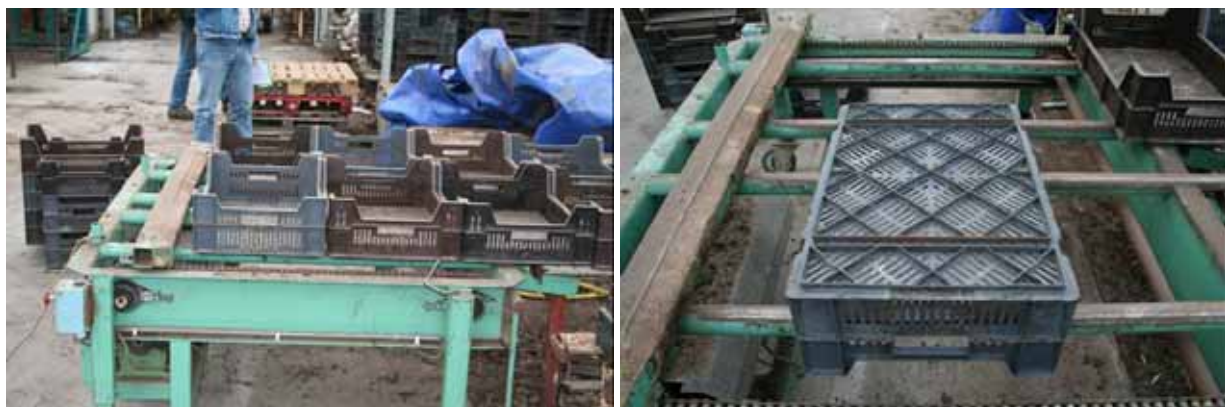
Duwapparaat (links) voor het inhalen van broeifust met speciaal profiel aan de onderkant (rechts) over tafels van buizen
