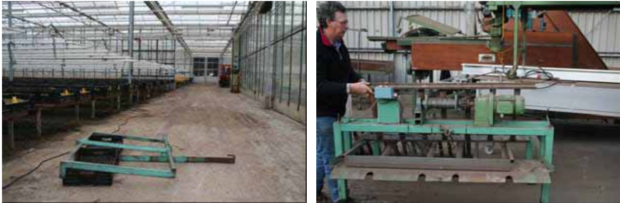
Trekstang (links) en lier met kabel (rechts) voor het uithalen van broeifust
