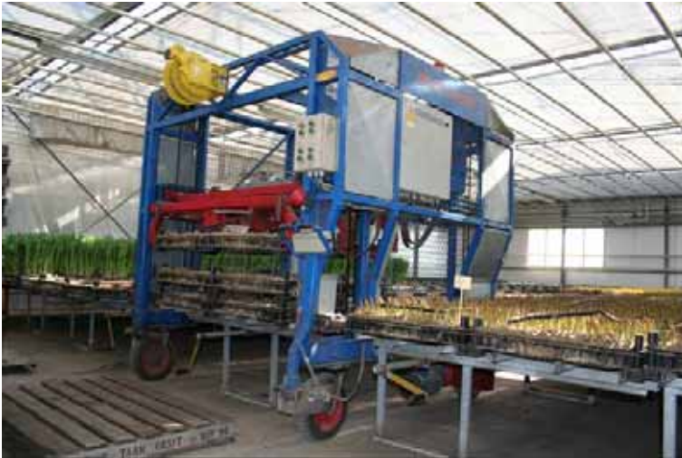
Zelfrijdende bakkenklem in portaalwagen
