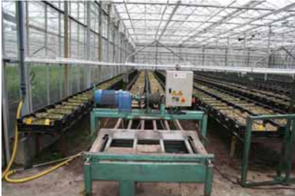
Duw- en trekapparaat voor het in- en uithalen van broeifust (zonder profiel) over tafels van buizen
