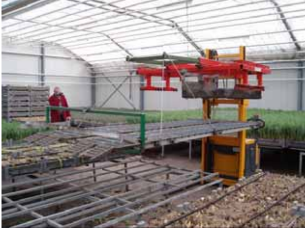
De pick-up wordt met behulp van de bakkenklem naar een andere kas verplaatst. Verplaatsing van tafel naar tafel gebeurt handmatig.
